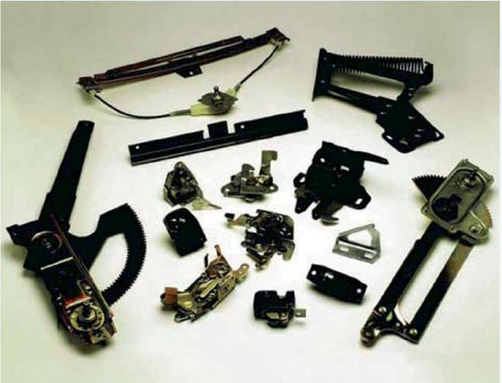
**Cerraduras, Levanta cristales; Bisagras de capot; Bisagras de baúl; Frenos de mano; Guías de vidrio; Pestillos de puerta**
